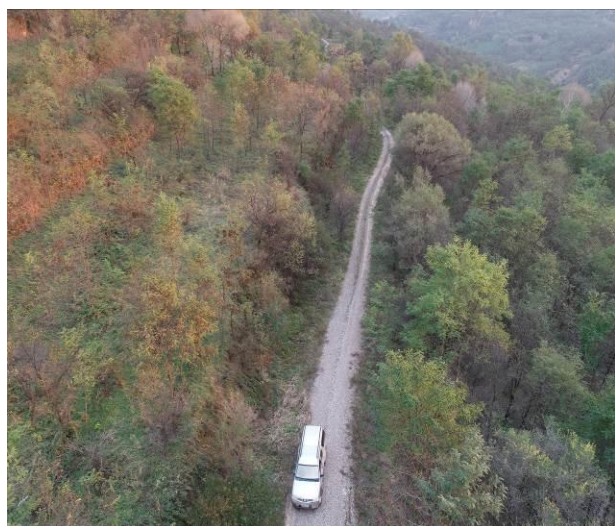
JH17P13 油井道路砾石压盖
