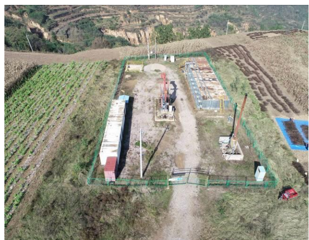
JH17P7 油井区裸露地表砾石压盖，植草绿化
